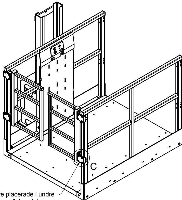
Induktionsgivare placerade i undre delarna av räckesstolarna
